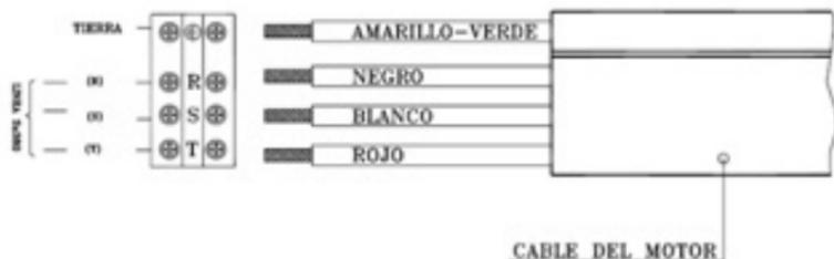
**La instalación debe estar provista de un interruptor (llave termo magnética) que provea una desconexión de todos los polos de la red de alimentación con una separación de al menos 3mm entre los contactos, de acuerdo a las normas nacionales vigentes.**
